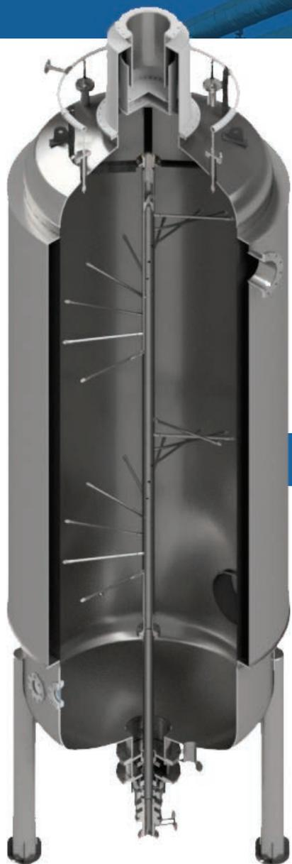
O **Condeterm CDT-2000®**, da **Spraying Systems**, usa tecnologia de película pulverizada, que separa rapidamente componentes mais voláteis dos menos voláteis usando transferência de calor indireta e pulverização com agitação do filme de levedura sob condições controladas.
